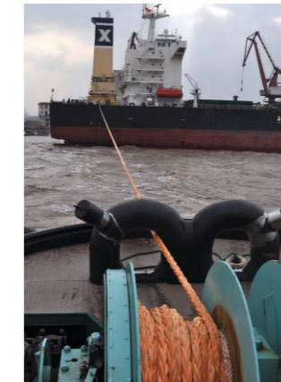
超高分子量聚乙烯缆绳应用于拖轮 The HMPE ropes applies to tug
